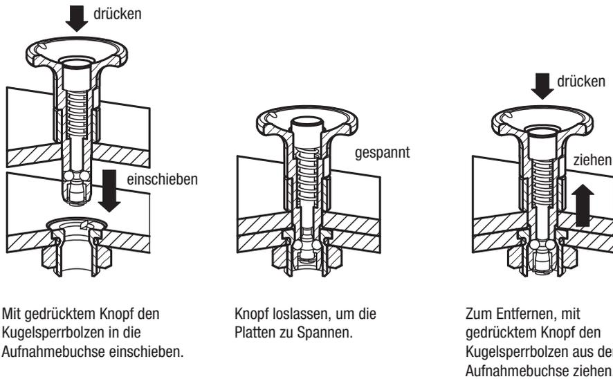
Mit gedrücktem Knopf den Kugelsperrbolzen in die Aufnahmebuchse einschieben.
